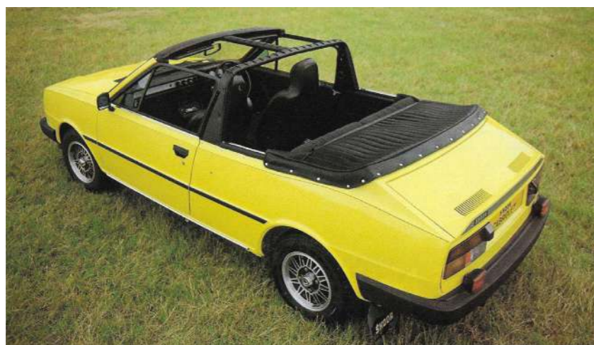
Rapid LDD Standard war mit dem Überrollbügel in Form eines H ausgestattet
