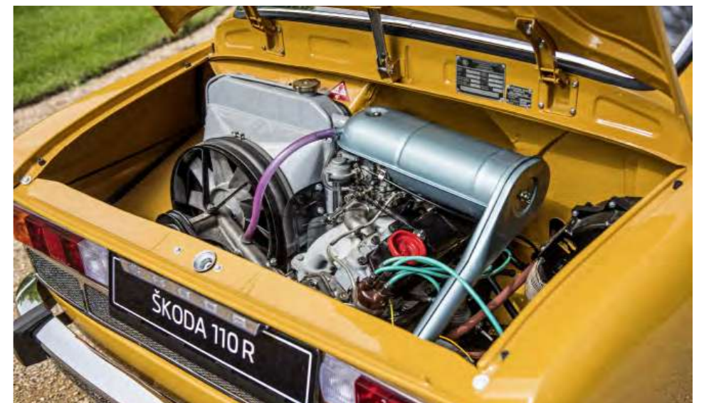
Neben dem Vierzylinder steht seitlich der Wasserkühler. Das spart die Verschlauchung zum Fahrzeugbug
