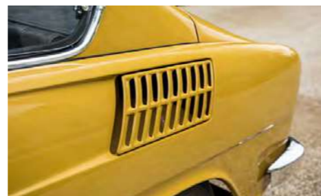
Kiemen weisen auf den Heckmotor hin
