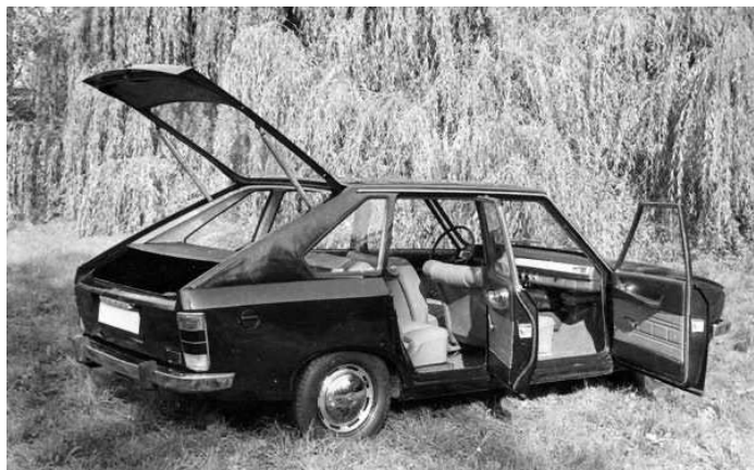
Die fünfte Tür im Fließheck im geöffneten Zustand mit Gasdruckfedern.
