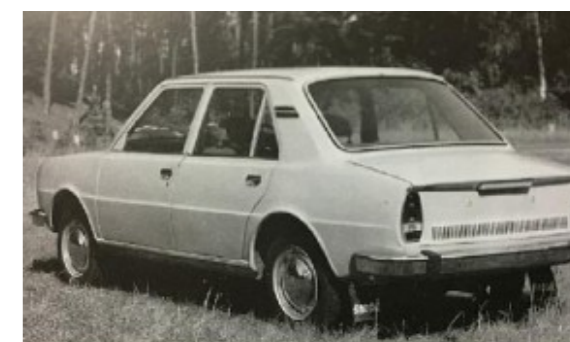
Der zweite Prototyp Š 742 hatte bereits Lüftungsgitter an den C-Säulen
