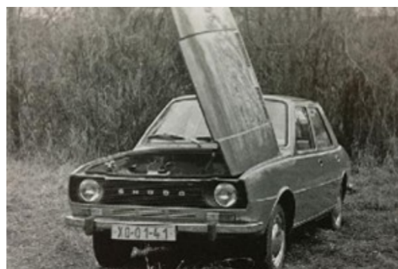
Beim Š 727 wurde die Kofferraumklappe erstmals seitlich angeschlagen
