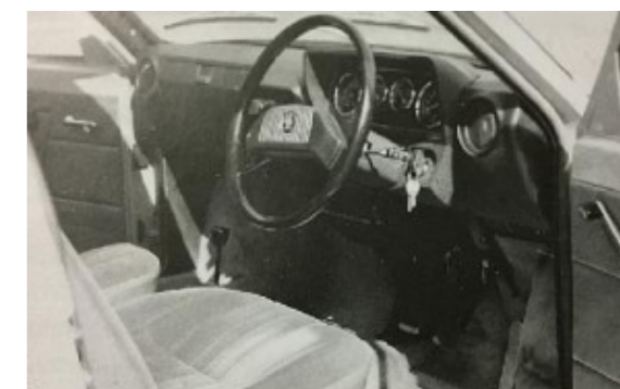
Armaturenbrett des zweiten Prototyps Š 742 mit Rechtslenkung, der Drehzahlmesser fehlte noch. Die Anordnung der Instrumente war spiegelverkehrt im Vergleich zur späteren Serie.
