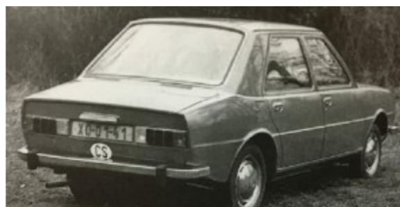
Das Heckblech der Karosserie des Š 727 besaß keine Kühlluftöffnungen, die Rücklichter waren horizontal angeordnet
