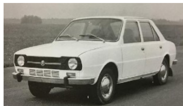
Der erste Prototyp des Š 742 mit Heckmotor und Frontkühler wurde im April 1973 fertiggestellt
