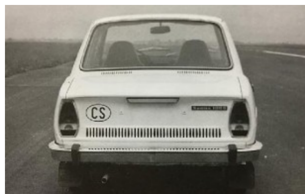
Zum ersten Mal erschienen bei der ersten Š 742 Limousine vertikal ausgerichtete tropfenförmige Rücklichter
