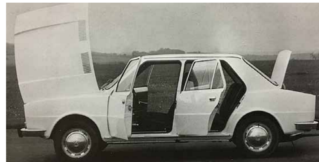
Der Kofferraumdeckel wurde wie beim Š 727 an der linken Seite angeschlagen
