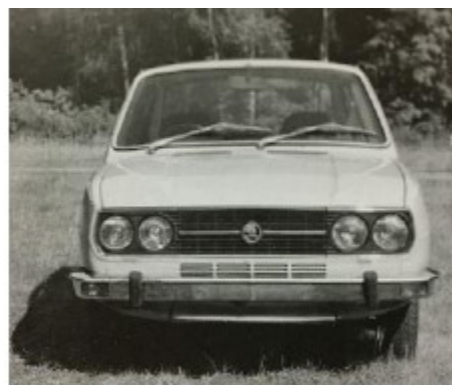
Die Front des Š 742/2 mit vier Scheinwerfern und einem kleinen Spoiler unter der Stoßstange
