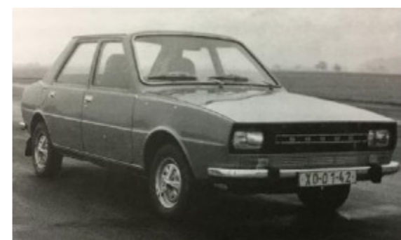
Dezember 1972: Das erste Auto des Typs Š 760 mit einer modifizierten Karosserie des Typs Š 727 und Frontantrieb
