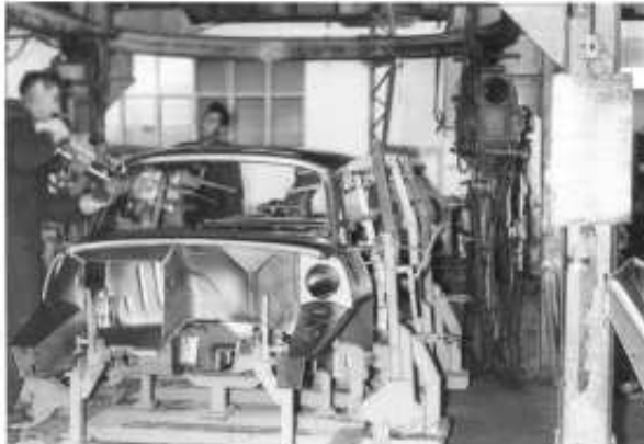
Karoserieschweißanlage im Trekka-Werk in Neuseeland. Hier entsteht die Karosserie eines S110L (Quelle: Todd Niall)
