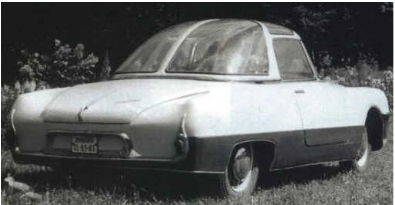
Skoda 440 Spartak Polytex Roadster (1956) – Bei Testfahrten flog das ultraleichte Original-Plexiglasdach
