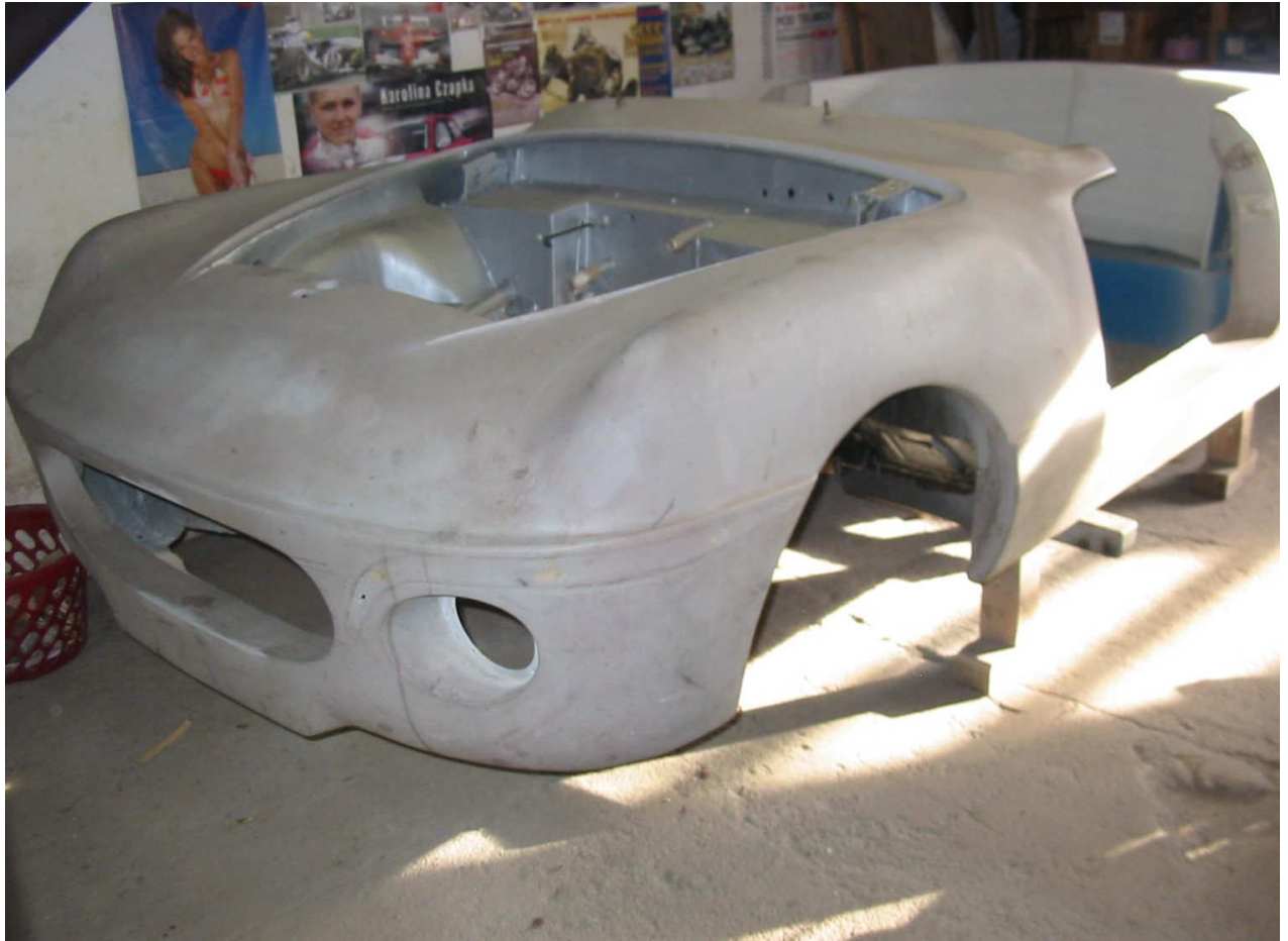
Skoda 440 Spartak Polytex Roadster (1956) - die Rohkarosserie beim Bau
