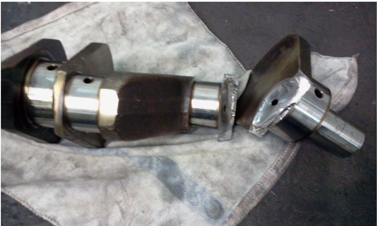
Die gebrochene Kurbelwelle wurde durch eine Ersatzwelle auf der Strecke ausgetauscht
