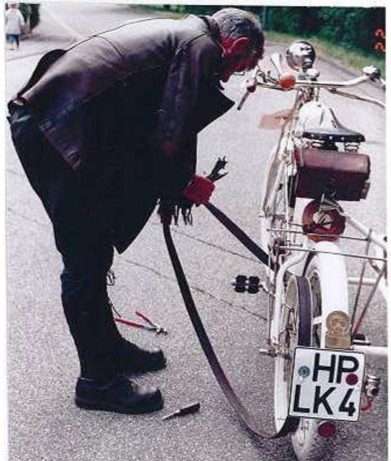
**Hier stellt er den Fahrriemen nach. Der Lederriemen wird gekürzt, mit der Lochzange ein Loch gestanzt und beide Enden mit Mutter und Schraube zusammengefügt.**
