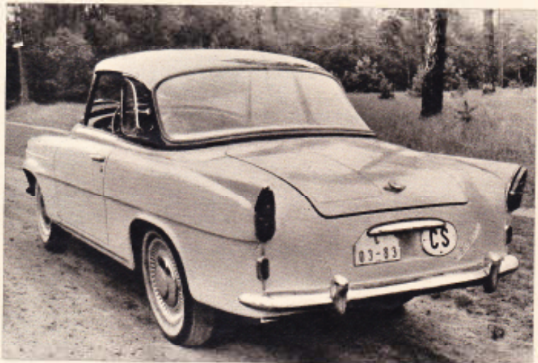
das Visieren beim Rückwärtsfahren und ermöglichen den Anbau dieser gegenüber früheren Typen wesentlich größeren Heckleuchten. Die Kofferklappe war verborgen worden, daher der große Spalt.
