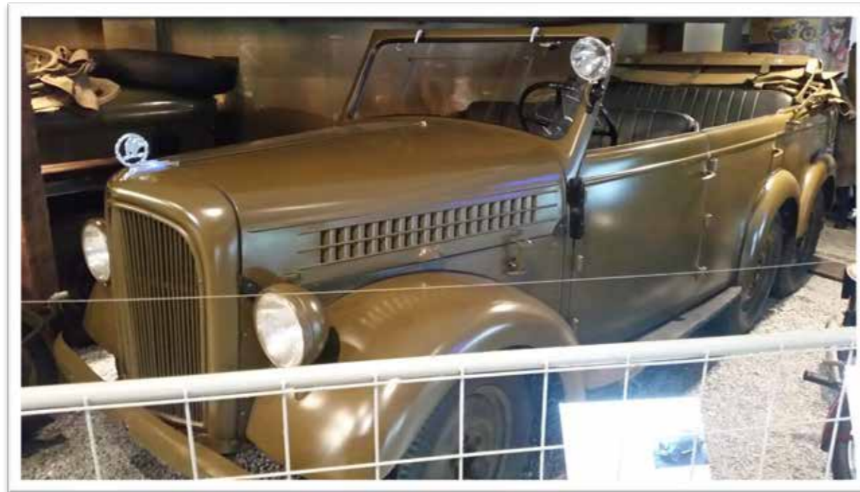
Skoda 903 Baujahr 1941. Es handelt sich um ein Kommandeursfahrzeug, welches letztlich für die Wehrmacht in einer Kleinserie von 42 Stück gebaut wurde. Die Entwicklung sowie Erprobung geschah jedoch noch im Auftrag der tschechoslowakischen Armee. Das Fahrzeug verfügt über einen 6-Zylinder mit einer Leistung von 55,2 KW bei einer Höchstgeschwindigkeit von 90 km/h.
