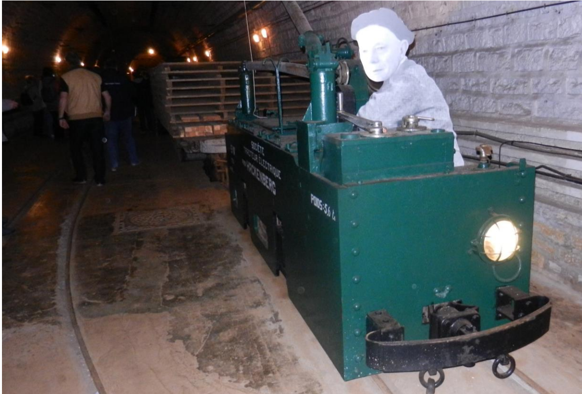
10 km Schmalspurgleise unter Tage zur Unterstützung der Logistik.
