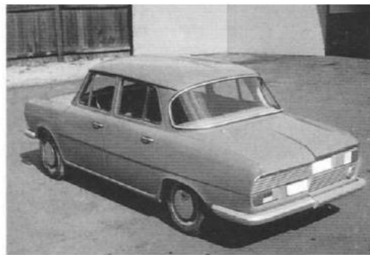
Die beiden Hälften des Modells unterschieden sich nicht nur in der Anordnung der Rückleuchten, sondern auch in der Form der Heckkotflügel.
