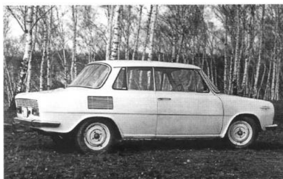
Der erste Prototyp des Š 717 Tudor. Die Rückleuchten sind noch unterhalb des Kühlluftgitters positioniert.
