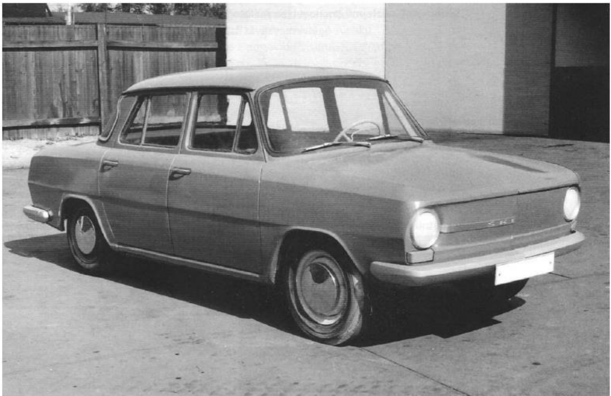
Ein Gipsmodell des modernisierten 1000 MB im Maßstab 1: 1 aus dem September 1963
