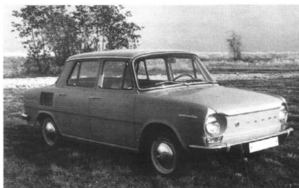
Der Prototyp Š 718 TS mit Doppelvergasern und 1107 ccm von 1965. Die Mulden unter den Türgriffen sind jetzt entfallen.
