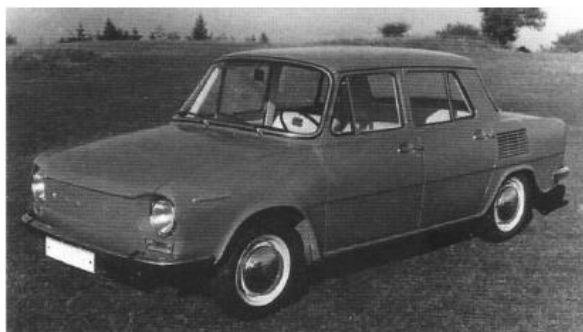
Modell Š 717 aus dem Herbst 1965 mit neuem Dach, breiter C-Säule und stärker konturierter Fronthaube.
