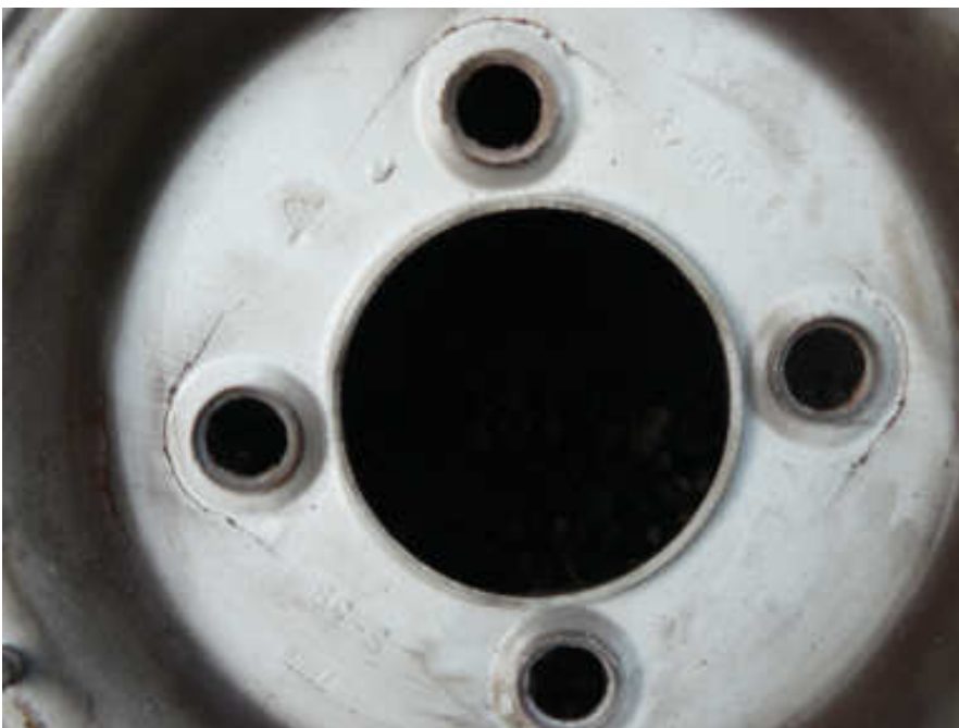
Bild Felge mit umlaufenden Anriss um die Befestigungslöcher
